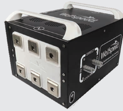
功率密度为 72 kW/L 的 600 kW 高性能双 3 相逆变器参考设计 [CRD600DA12E-XM3]
